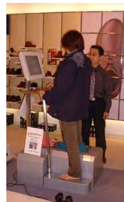
図3.3.2 静的な足形状計測システム「INFOOT」
