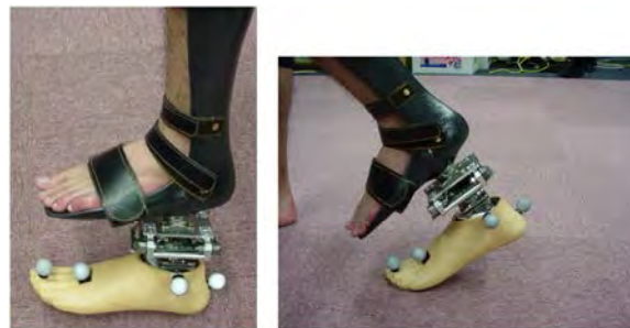
図3.4.9 人工義足を用いた装着型6軸床反力計
