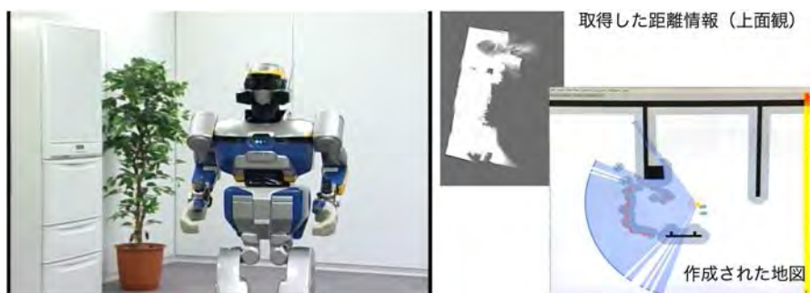
図3. 4. 13 ヒューマノイドロボットによる位置認識・地図作成・障害物発見
