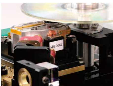
(b) 高精度2軸アクチュエータとスピンドル周りの外観写真.
