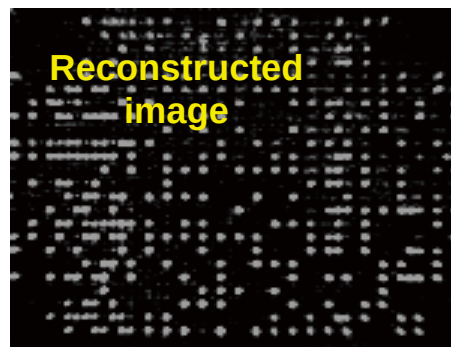
図 23 MOSLM を用いたコリニアホログラム記録再生試験結果:O to O(上), 再生像(下).
