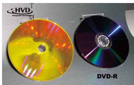
図 60 コリニア方式による動画の記録再生に使用したホログラム光ディスク: HVD (直径 12 センチで, 右側に置かれた現行DVDやCDと同サイズ).
