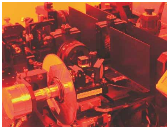
図 59 連続回転ホログラム光ディスクによる動画記録再生光学系.
